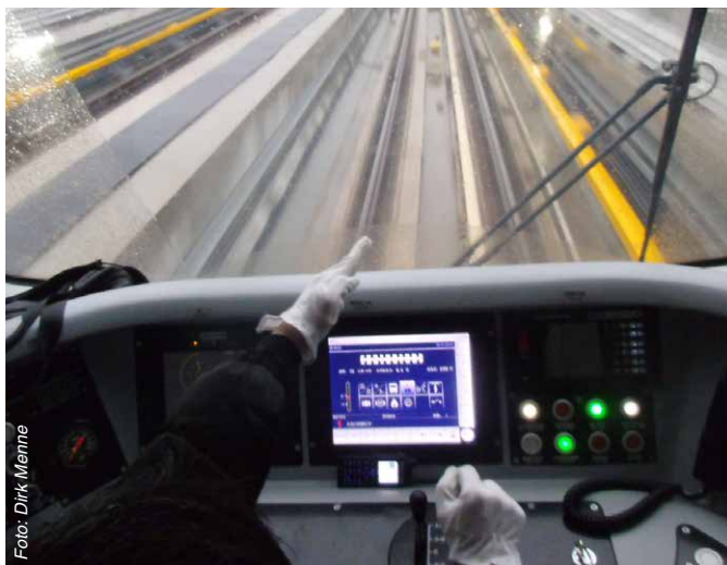
Triebfahrzeugführer bei der SMOC (Shanghai Metro Operating Company) zeigt auf das Signal und sagt die Bedeutung laut an
